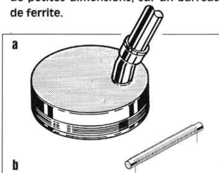
Figure 6 - La grande bobine (a) est fabriquée à partir d'une pièce en PVC destinée normalement à obturer des conduits d'écoulement. Pendant que vous avez à portée de main la scie à métaux et le tube de colle à PVC, continuez : un tube et un coude à 135° du même métal constituent le manche. La petite bobine (b) est faite sur un bâtonnet de ferrite.
