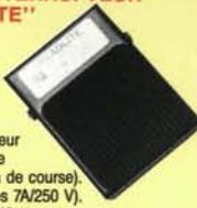
Pédale interrupteur à double détente (Mi-course et fin de course). (2 micro-switches 7A/250 V). Avec patin anti-dérappant. Matériel professionnel pour usage intensif. Idéale pour télécommande de perceuse, etc...
