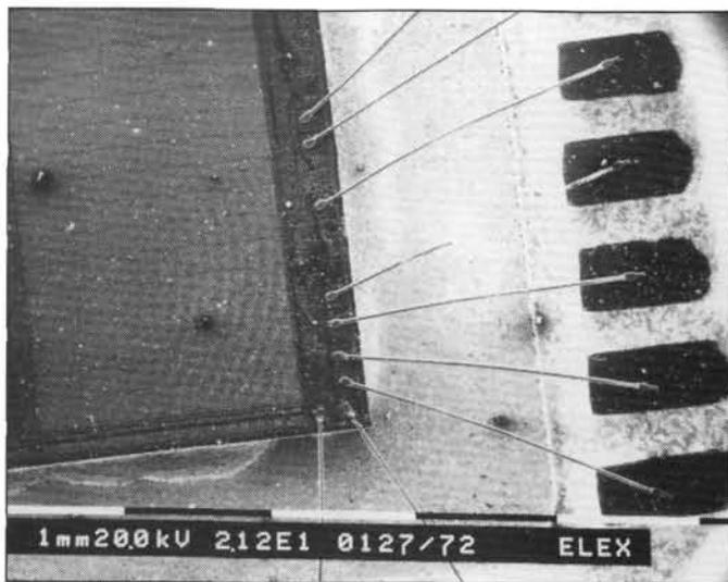
Figure 4 - L'intérieur d'une EPROM (circuit de mémoire programmable effaçable) dont la santé laisse beaucoup à désirer : elle présente un fil de connexion brûlé et quelques cratères qui ne disent rien qui vailent.
