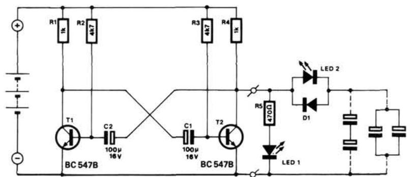
Figure 13 – Le générateur expérimental permet de tester le comportement de condensateurs montés en série ou en parallèle. La LED2 permet d'observer l'intensité du courant qui traverse le condensateur.
