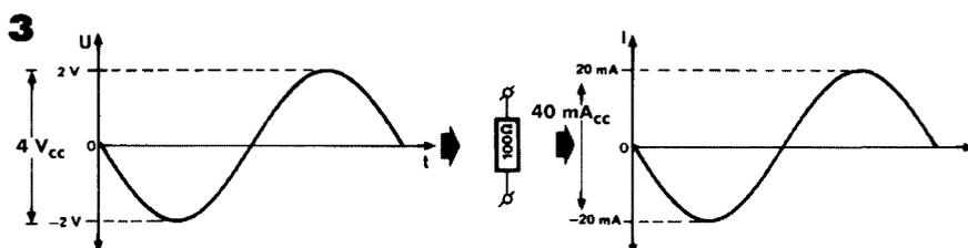
Figure 3 – La loi d'Ohm s'applique à la valeur crête à crête d'une tension alternative.
