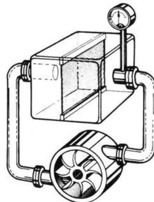
Figure 7 – La conduite représentant le condensateur est séparée en deux par une membrane. L'eau ne peut pas la traverser mais ses variations de pression sont transmises.
