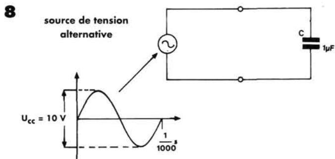
Figure 8 – Ici un courant circule bien qu'aucune liaison conductrice n'existe, le condensateur ne bloque pas la tension alternative.
