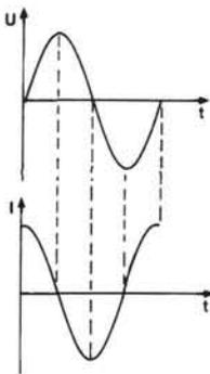
Figure 11 – Les essais avec le montage de la figure 5 permettent de représenter le courant à travers un condensateur soumis à une tension alternative : le courant est en avance d'un quart de période sur la tension. Cela s'appelle le déphasage.
