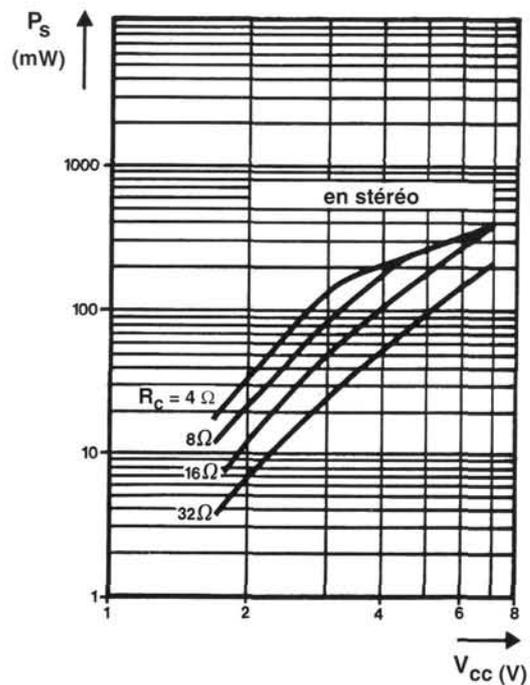
Figure 4 - Ces courbes (tracées sur papier logarithmique) vous permettent de lire ce que seront les performances maximales ( $P_s$ ) de votre amplificateur pour une tension d'alimentation ( $V_{CC}$ ) et une impédance de haut-parleur ou de casque données ( $R_c$ ). Quelles valeurs ont été reportées dans le tableau ci-dessous.
