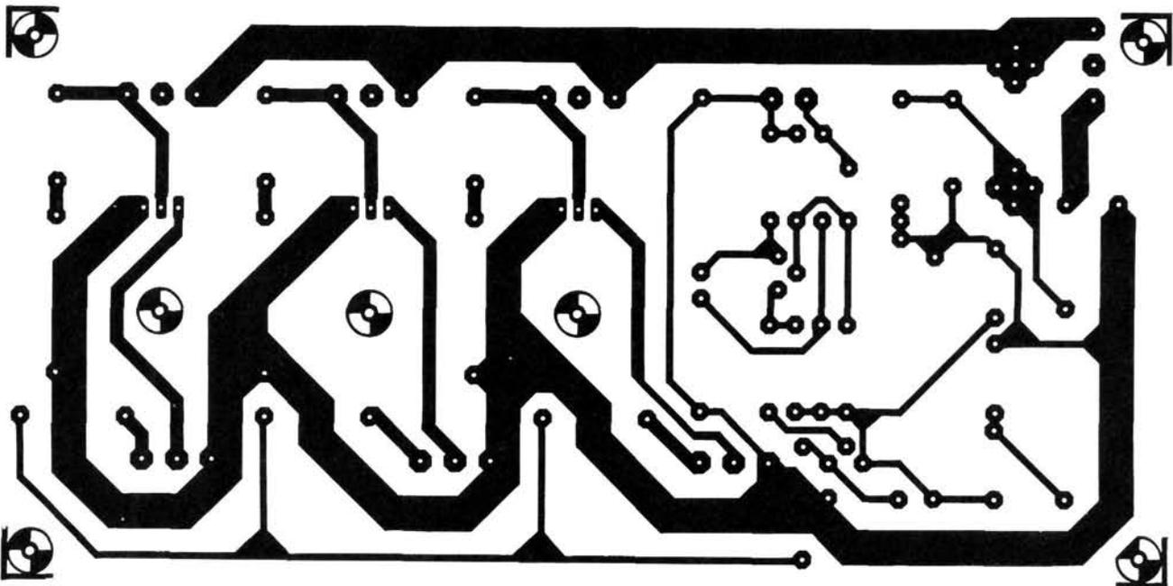
Figure 2 - Le circuit imprimé et l'implantation des composants : la largeur des pistes correspond à l'intensité des courants qui y circulent. Notez la présence du strap à gauche du potentiomètre P1 et sur la droite du transistor T2.
