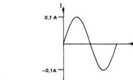
Figure 9 – Le courant alternatif qui circule à travers une résistance a la même forme que la tension qui le provoque : ainsi en a décidé la Loi d'Ohm.
