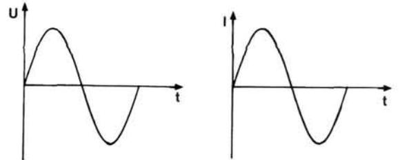
Figure 12 – La tension et le courant aux bornes d'une résistance ne sont pas déphasés, ils existent simultanément.
