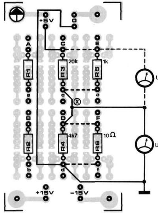
Figure 10 - Nous construisons un diviseur à plusieurs étages avec R2, R4 et R5. La tension au point X est supérieure à celle du point Y. Calculez les valeurs et comparez le résultat du calcul avec celui des mesures.
