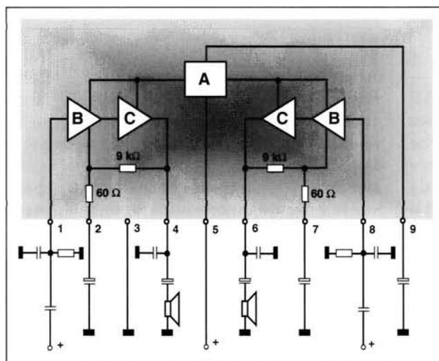
Figure 1 - L'essentiel du circuit intégré, tel que le propose le fabricant : A est le circuit de préaccentuation (*bias*), B sont des préamplificateurs et C les étages de sortie. Le gain de cet amplificateur stéréophonique est fixé par les deux résistances de 9 kΩ et de 60 Ω. Il peut donc être diminué par la mise en série avec la résistance de 60 Ω, d'une autre résistance, sur les broches 2 et 7.
