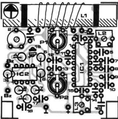
Figure 2 - Le dessin des pistes et l'implantation des composants du récepteur. Notez que toutes les résistances sont montées debout pour limiter l'encombrement.
