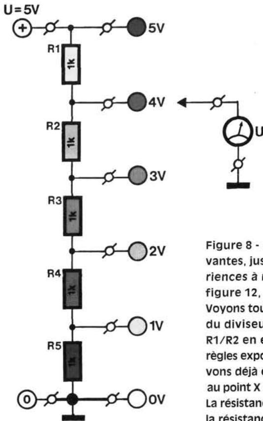
Figure 7 - Un diviseur à 5 résistances permet d'obtenir les tensions de 0 à 5 V par pas de 1 V.
