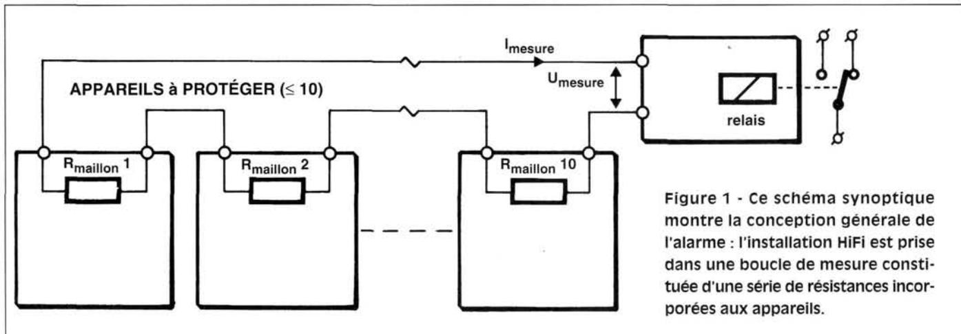
Figure 1 - Ce schéma synoptique montre la conception générale de l'alarme : l'installation HiFi est prise dans une boucle de mesure constituée d'une série de résistances incorporées aux appareils.
