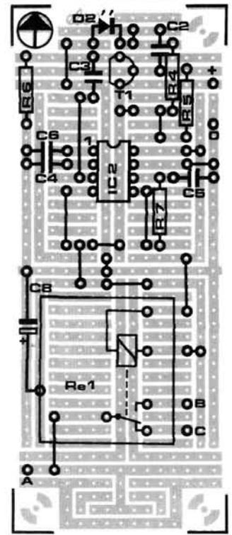
Figures 2 et 3 - L'implantation des composants de l'émetteur ou clef, et de la serrure ou récepteur.
