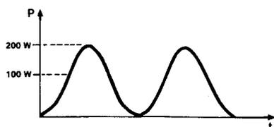
Figure 5 – La puissance efficace d'une tension sinusoïdale est le produit de la tension efficace par le courant efficace.
