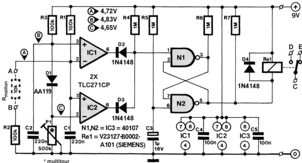
Figure 2 - L'essentiel du schéma tient dans le comparateur à fenêtre constitué par deux comparateurs. Pour lui faire suite, nous trouvons un joyeux mélange de câblé et de circuits logiques à drain ouvert.
