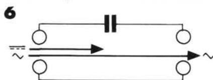
Figure 6 – Le condensateur ne conduit que les tensions alternatives. Il permet d'extraire la tension alternative d'un mélange de tension continue et de tension alternative.
