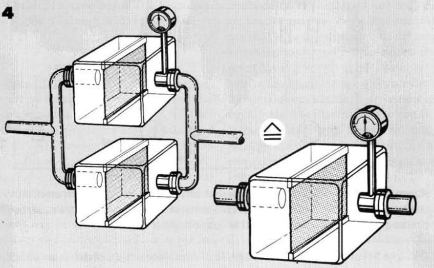
Figure 14 – Deux « condensateurs » hydrauliques montés en parallèle peuvent être remplacés par un autre, avec une membrane de surface double.
