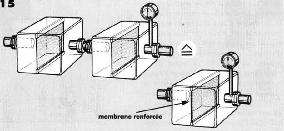
Figure 15 – Le montage série de deux modèles hydrauliques correspond évidemment à un modèle avec une membrane renforcée.
