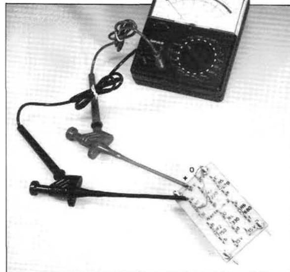
Figure 3 - Lors de la mesure du courant à travers une charge (résistance), l'ampèremètre doit être branché en série dans le circuit. L'intensité du courant à travers la charge ne dépend que de la valeur de la résistance si la tension est constante. Plus la résistance est faible, plus fort est le courant. La mesure de la tension et celle de l'intensité permettent de calculer la valeur de la résistance.
