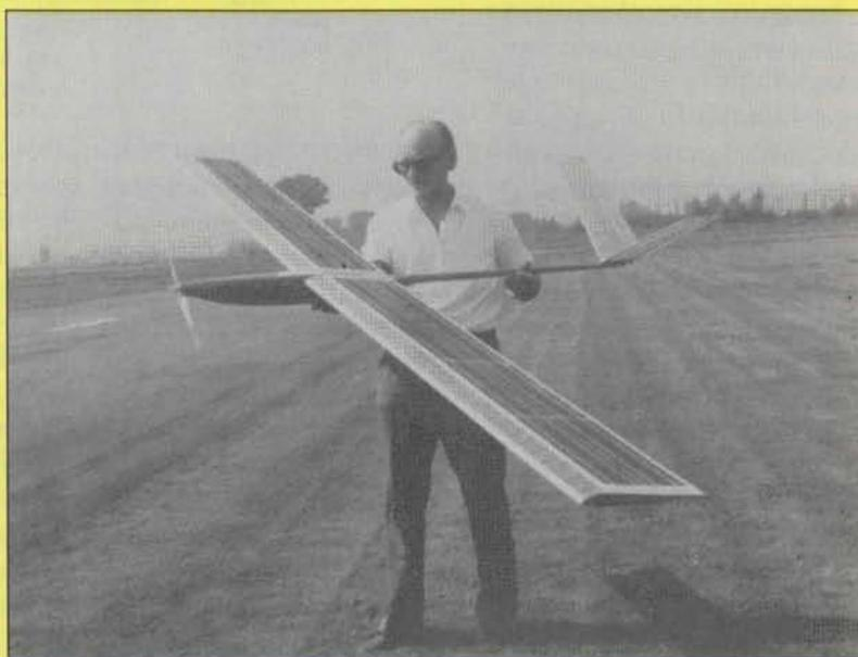
Un planeur à moteur quasiment silencieux : le Poly, de 3,40 m d'envergure. Son constructeur, Helmut Bruss, l'a équipé d'un total de 128 cellules solaires qui lui permettent de voler même par faible ensoleillement.
