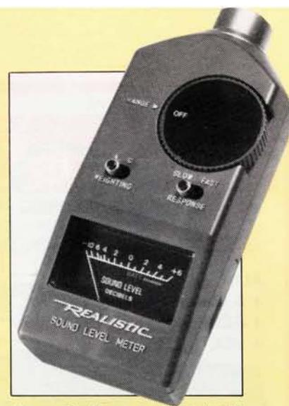
Figure 6 - Un sonomètre à prix « amateur ». Il est utilisable pour mesurer le rendement de haut-parleurs ou le bruit de modèles réduits, pour ne citer que ces deux exemples.
