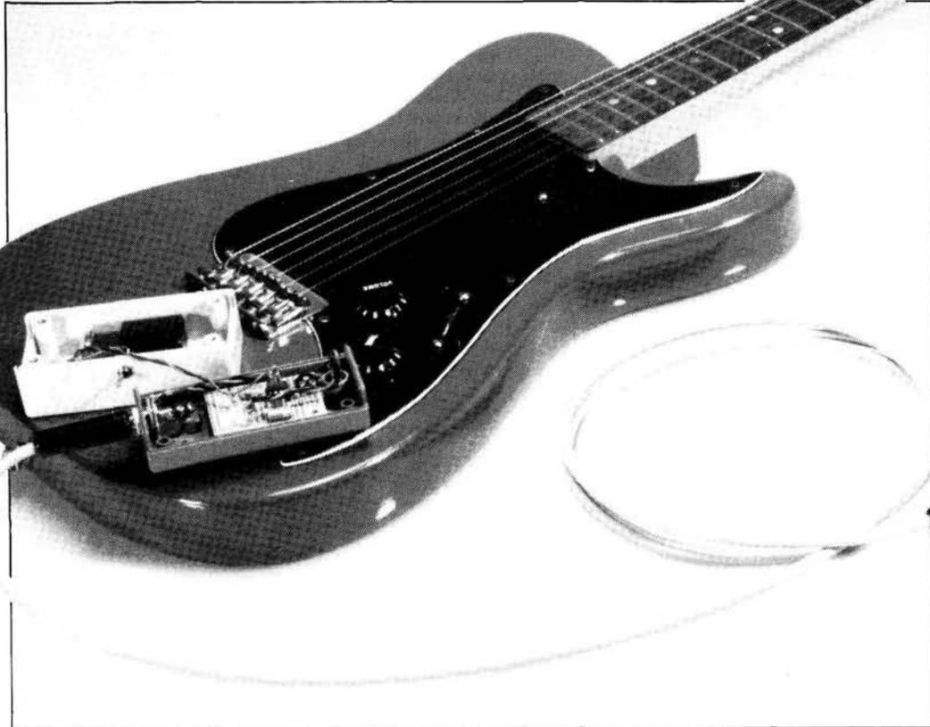
**La fonction du préamplificateur de la sono d'un guitariste est de relever le niveau du très faible signal électrique fourni par l'instrument, de manière à ce qu'il puisse être amplifié par l'étage de puissance.**
