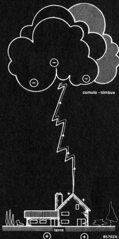
Figure 2 - a. Lorsque la tension a atteint une valeur suffisante, le nuage pointe un doigt vers la terre, sous forme d'un pré-décharge pilote, au même potentiel que le bas du nuage. b. L'éclair pilote progresse par bonds vers la terre. c. La terre pointe elle aussi un doigt sous la forme d'une décharge en retour qui vient à la rencontre de la décharge pilote. d. Dzing ! c'est la rencontre. Le chemin est frayé, la décharge principale peut se produire jusqu'à ce que les éclairs successifs aient évacué toute la charge du nuage.
