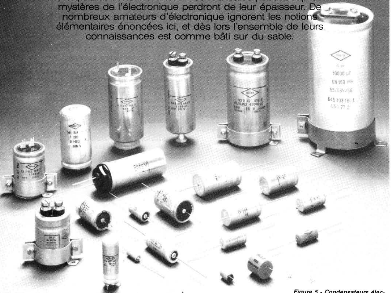
Figure 5 - Condensateurs électrolytiques reconnaissables à leur boîtier en aluminium.
