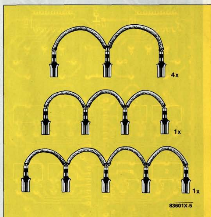
Figure 5 - En plus des ponts de câblage permettant de relier 2 picots entre eux, il est bon de disposer de ponts capables relier 3, 4 et même 5 picots mâles entre eux. Ceci permet de limiter le nombre des picots implantés sur la platine.
