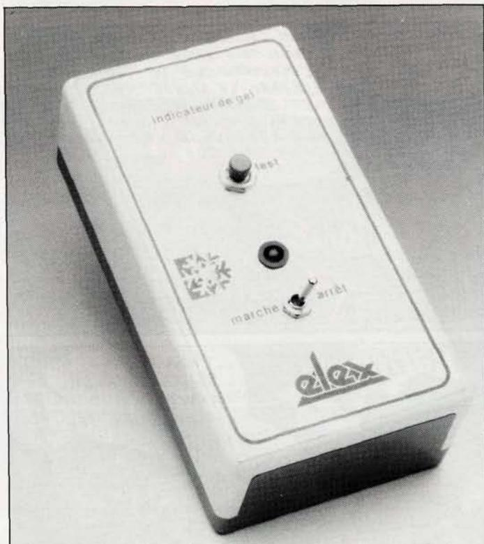
Figure 1. Un des prototypes de l'indicateur de gel. La sonde de cet exemplaire (invisible sur la photo) est placée à l'arrière du coffret derrière la paroi du fond ajourée par quelques trous pour permettre la circulation de l'air.
