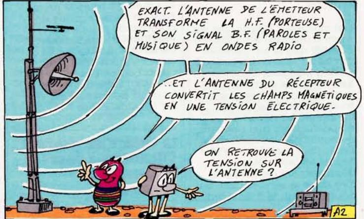
...ET L'ANTENNE DU RÉCEPTEUR CONVERTIT LES CHAMPS MAGNÉTIQUES EN UNE TENSION ÉLECTRIQUE.
