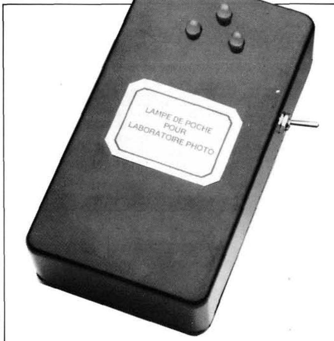
Figure 1 - L'éclairage fourni par les trois LED de cette lampe de poche suffit pour s'orienter sans tâtonner dans un laboratoire photo. Il permet aussi de lire une notice d'emploi ou de rechercher un objet tombé à terre.
