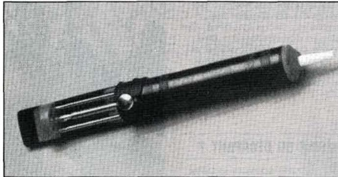
*La pompe à souder est munie à une extrémité d'un embout en téflon et à l'autre d'un piston stabilisé par un double guidage et un dosset hémi-cylindrique (document Express).*
