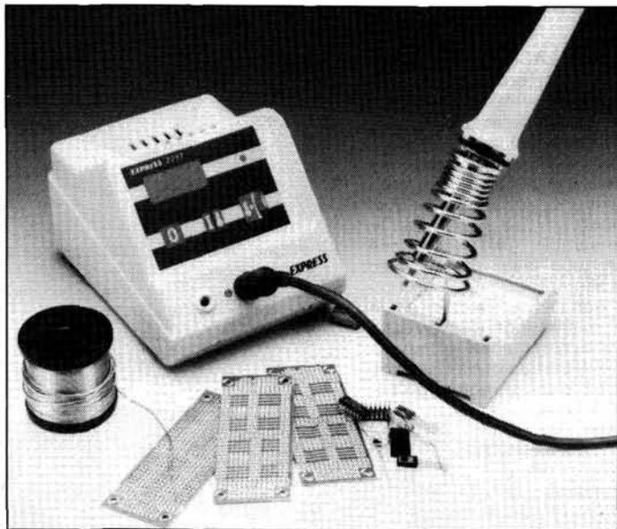
Poste de soudage thermorégulé fabriqué en France par EXPRESS. Boîtier alimenté en 220 V, double isolation. Fer 48 W / 24 V. Panne "mini tournevis" longue durée. Température réglable en continu entre 150 et 400°C. Suppression des crêtes parasites par découpage et commutation au zéro volt. Prise équipotentielle Ø 4 mm
