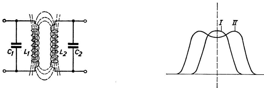
Fig. 25. Deux circuits, accordés sur la même fréquence. Couplage plus grand que le «couplage critique».
