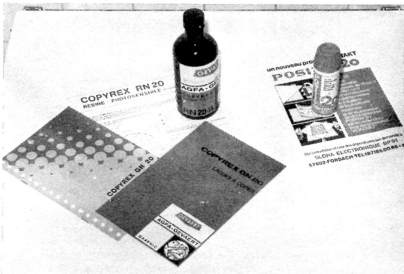
*Un échantillonnage de résines photosensibles susceptibles d'être utilisées (présentation en bouteilles et en bombes).*
