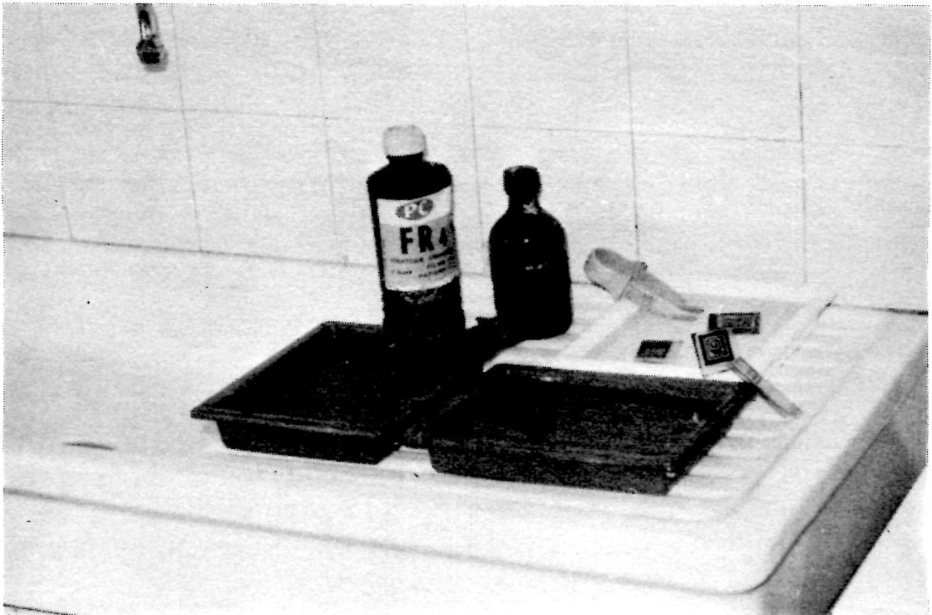
*Deux ou trois cuvettes et un minimum de produits chimiques suffisent pour traiter les plan films « lith » dans de bonnes conditions.*
