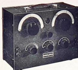
Fournit une tension alternative de forme sinusoïdale pure avec une puissance de sortie élevée constante (max. 400 mW) sur une gamme de fréquence réglable de 30-15000 p/s. Atténuateur variable incorporé. Etalonnage de zéro à l'aide d'un petit indicateur à rayons cathodiques. L'appareil se prête à toutes les mesures en basse fréquence de la pratique et peut aussi être utilisé pour fournir la tension de mesure au
