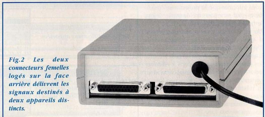
Fig.2 Les deux connecteurs femelles logés sur la face arrière délivrent les signaux destinés à deux appareils distincts.
