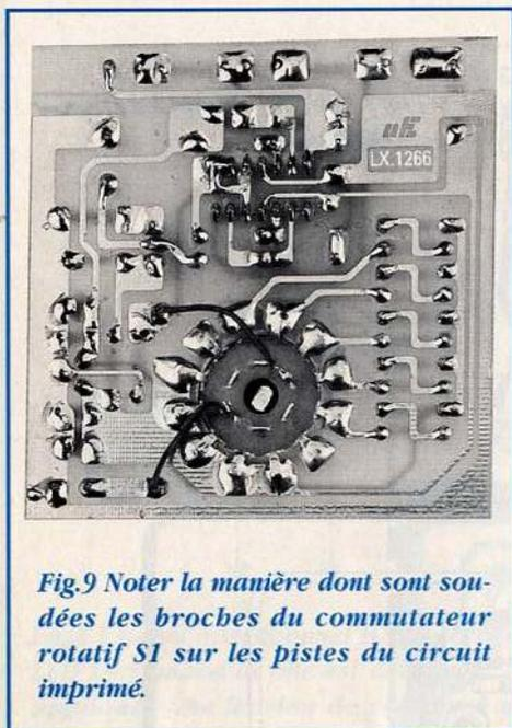
**Fig.9** Noter la manière dont sont soudées les broches du commutateur rotatif S1 sur les pistes du circuit imprimé.
