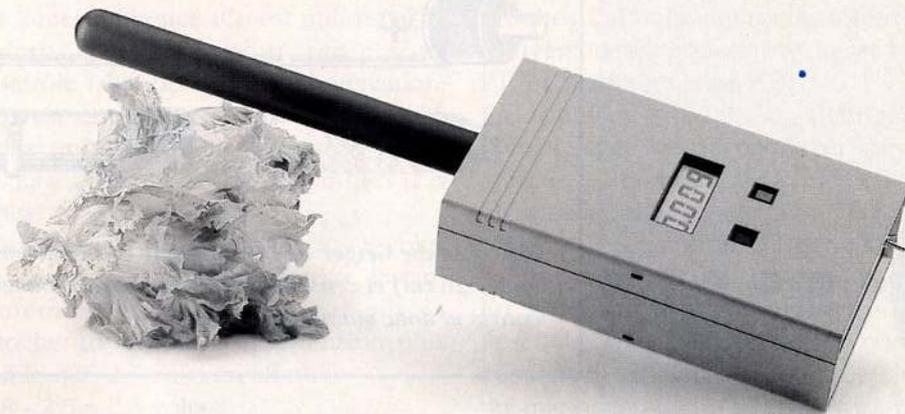
*Fig.4 Le compteur Geiger permet de contrôler si les légumes sont radioactifs et si les objets émettent de la radioactivité.*
