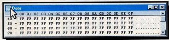
Fig.92 Le sous-menu GOTO ADDRESS permet de se positionner directement à l'adresse hexadécimale de l'emplacement mémoire dans lequel est mémorisé la variable.
