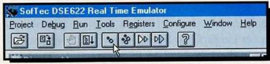
Fig.89 Commencer à simuler le programme BTEST.PRJ en se positionnant sur l'étiquette RIPETI mémorisée à l'adresse 8B6 figurant dans la colonne ADD.
