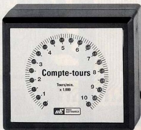
Pour son fonctionnement, le signal est prélevé sur le primaire de la bobine d'allumage sur la ligne venant du rupteur ou du transistor de découpage s'il s'agit d'un allumage électronique.
