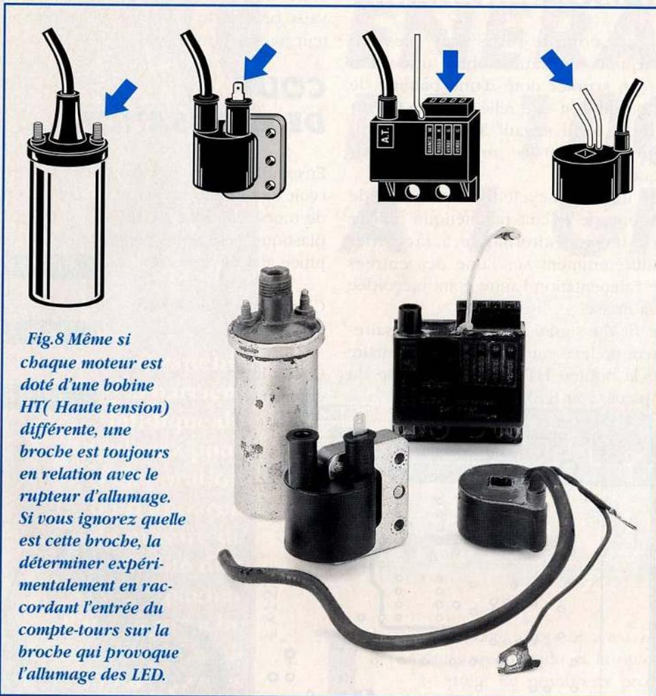
**Fig.8** Même si chaque moteur est doté d'une bobine HT ( Haute tension) différente, une broche est toujours en relation avec le rupteur d'allumage. Si vous ignorez quelle est cette broche, la déterminer expérimentalement en raccordant l'entrée du compte-tours sur la broche qui provoque l'allumage des LED.
