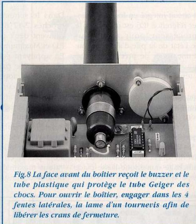
Fig.8 La face avant du boîtier reçoit le buzzer et le tube plastique qui protège le tube Geiger des chocs. Pour ouvrir le boîtier, engager dans les 4 fentes latérales, la lame d'un tournevis afin de libérer les crans de fermeture.
