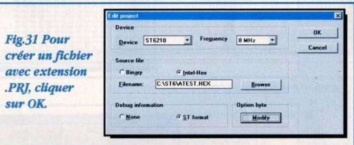
*Fig.31 Pour créer un fichier avec extension .PRJ, cliquer sur OK.*
