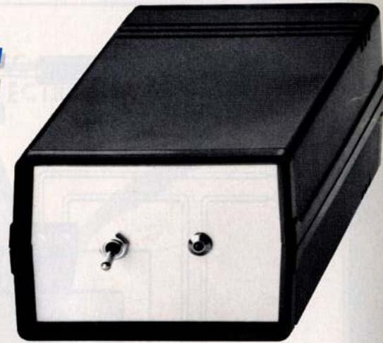
*Ce montage placé dans un élégant boîtier plastique noir permet de recharger toute batterie sèche de 12 volts dont la capacité est inférieure à 3 ampères/heure.*
