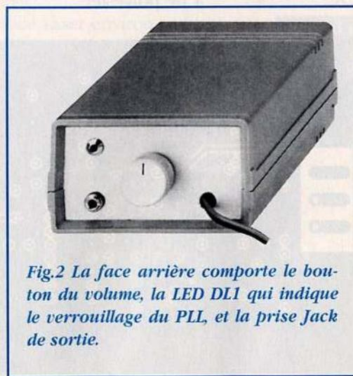
Fig.2 La face arrière comporte le bouton du volume, la LED DL1 qui indique le verrouillage du PLL, et la prise Jack de sortie.
