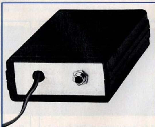
*Fig. 8 Sur la face arrière, fixer le connecteur Jack femelle recevant le microphone. Le trou visible à gauche, laisse passer les deux fils rouge et noir de l'alimentation 12 volts.*
