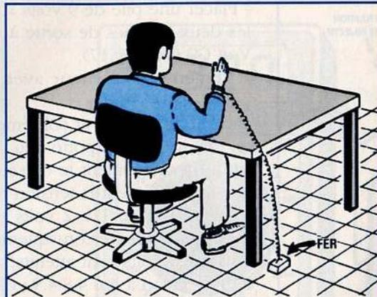
Fig.16 Raccorder à un poids en fer placé au sol, l'extrémité du fil liée à votre poignet.
