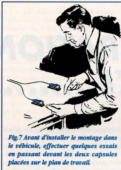
Fig.7 Avant d'installer le montage dans le véhicule, effectuer quelques essais en passant devant les deux capsules placées sur le plan de travail.
