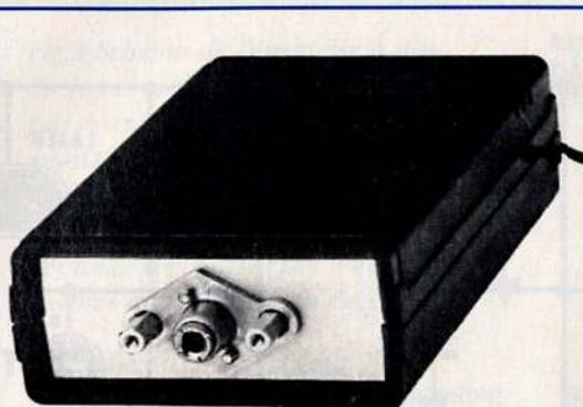
*Fig. 7 La face avant de l'émetteur FM comporte le porte-objectif et les deux entretoises en laiton, nécessaires à la fixation du testeur optique utilisé pour le réglage.*
