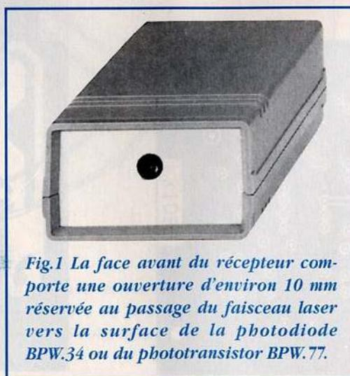
Fig.1 La face avant du récepteur comporte une ouverture d'environ 10 mm réservée au passage du faisceau laser vers la surface de la photodiode BPW.34 ou du phototransistor BPW.77.
