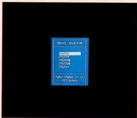
Fig.16 Sur l'écran s'affiche une fenêtre avec tous les types de ST62. Avec les touches de direction chercher la référence ST62E25 puis valider par Entrée.
