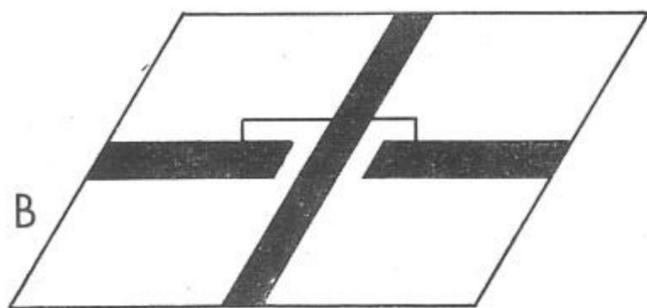
Fig. 2-B - Utilisation d'un «pont» placé du même côté que les connexions: le conducteur utilisé doit être soulevé afin d'éviter le contact avec l'autre ruban de cuivre.
