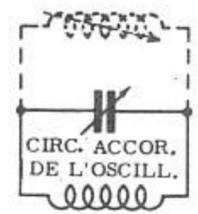
Fig. 18 - Le tube à réactance se comporte comme une inductance variable (en pointillé), reliée en parallèle avec le circuit accordé.
