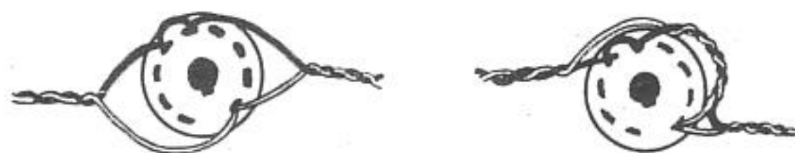
Fig. 8 - Moyen utilisé pour annuler le flux magnétique produit par les connexions des filaments. A droite, incorrect; à gauche, correct.
