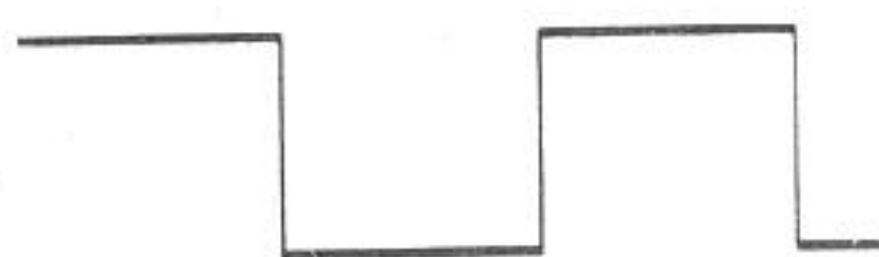
Fig. 5 - Forme d'onde du signal de commutation, en l'absence de signaux d'entrée.
