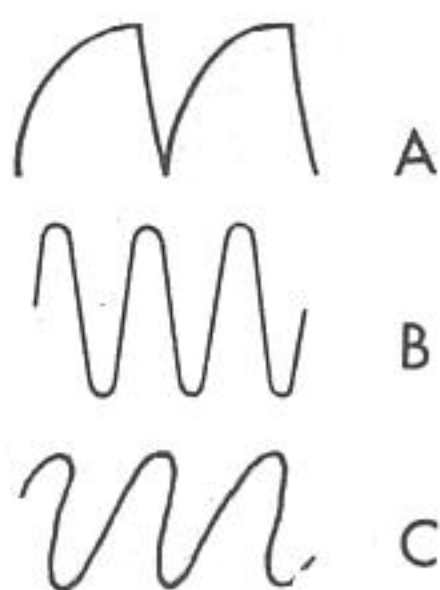
Fig. 12 - Formes d'onde de la tension de sortie en fonction du taux de réaction. La forme B est évidemment la meilleure.
