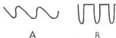
Fig. 8 - En A, variante obtenue en faisant  $C1 = 0,5 \mu F$  (fig. 6). En B, forme du courant dans la charge.
