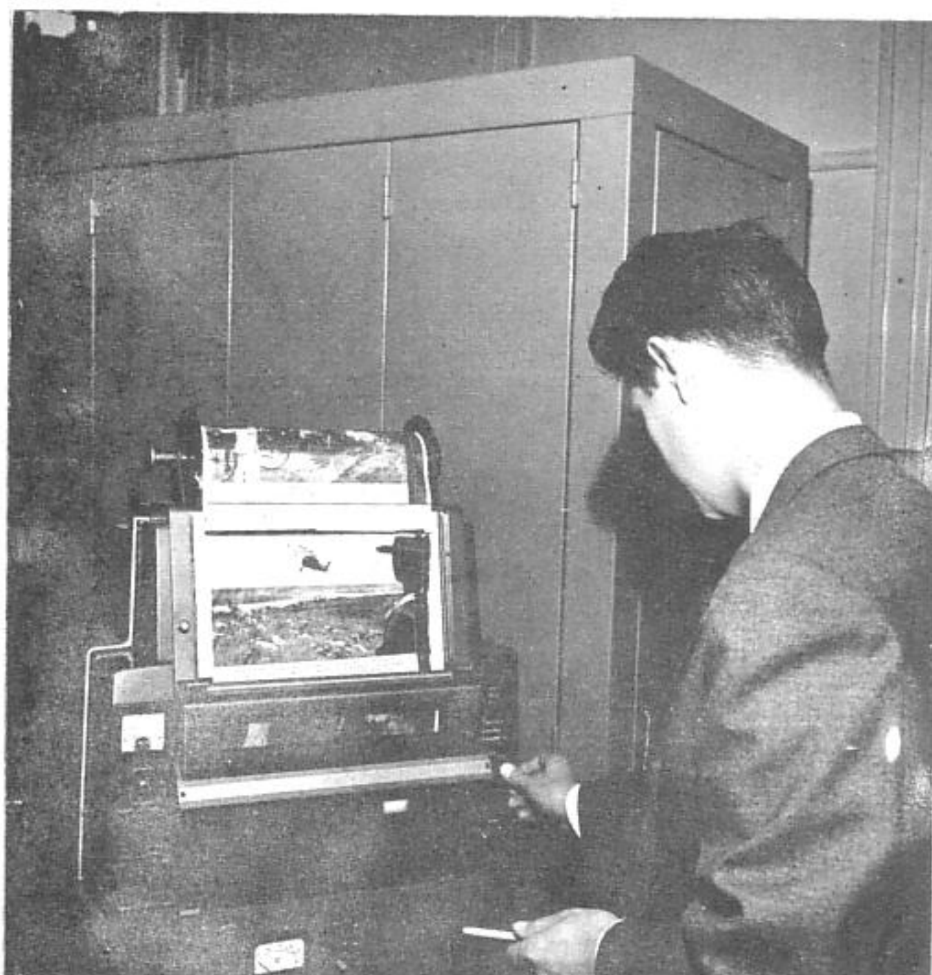
Un appareil récepteur du système de transmission par radio. Le cliché qui se déroule à la partie supérieure n'est qu'une image de contrôle. La photo elle-même, est reçue sur papier sensible dans un cylindre hermétique et les «signaux» envoyés sont enregistrés sur bande magnétique.
