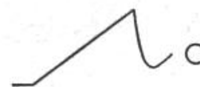
C - Forme résultant d'une réponse échéante aux hautes fréquences.
