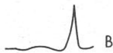
B - Forme résultant d'une réponse échéante aux basses fréquences.
