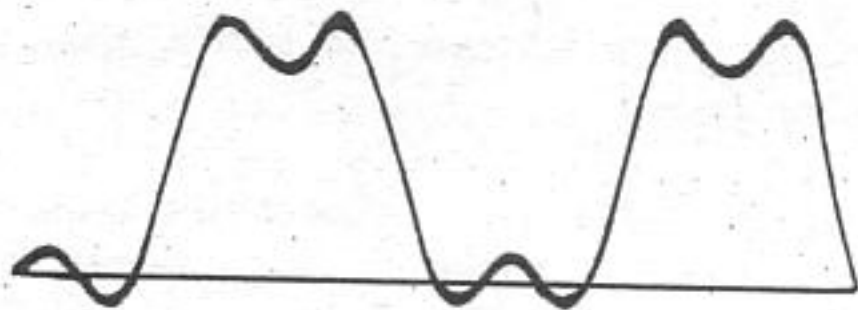
Fig. 13-B - En élargissant la bande passante, la forme d'onde de sortie s'améliore.
