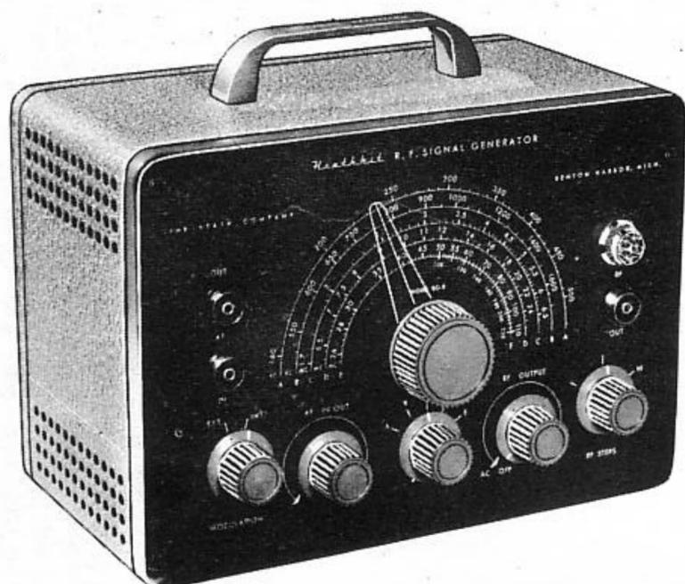
L'oscillateur modulé (également appelé « générateur HF ») type « SG-8 », que nous décrivons ici, est un instrument à usages multiples, d'un emploi facile et d'un fonctionnement sûr. Sa réalisation ne présente aucune difficulté particulière, car le montage est basé sur l'emploi d'étages oscillateurs analogues à ceux décrits dans la leçon précédente.
