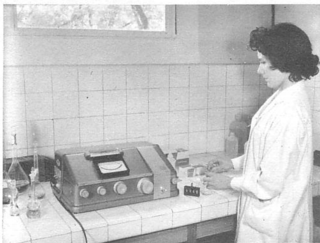
Fig. 2 - Contrôle au spectrophotomètre des oxydes émissifs qui seront déposés sur les cathodes. (phot. Deschamp) (doc. Mazda).
