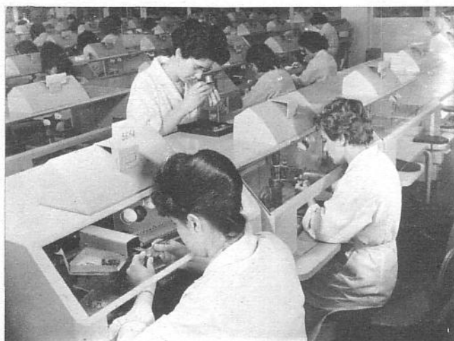
Fig. 3 - Lors du montage des tubes, des contrôles par prélèvement permettent de s'assurer que la précision à chaque poste de travail reste bien dans les tolérances imposées. (phot. Deschamp) (doc. Mazda).
