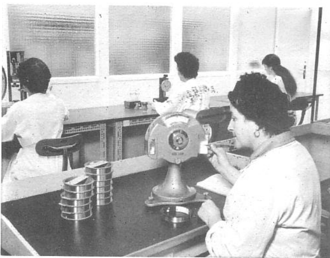
Fig. 1 - Le bon fonctionnement des tubes dépend beaucoup de la qualité des matières premières; aussi sont-elles vérifiées soigneusement dès leur livraison. Nous voyons ici le contrôle des fils à l'aide d'une balance de torsion. (phot. Deschamp) (doc. Mazda).
