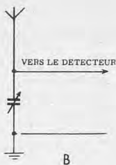
Fig. 4-B - On peut également changer la « longueur électrique » d'une antenne en ajoutant une capacité.
