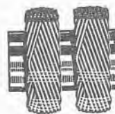
Fig. 16 - Deux enroulements du type « nid d'abeilles »; ils permettent d'obtenir des coefficients de self-induction élevés sous des dimensions réduites.
