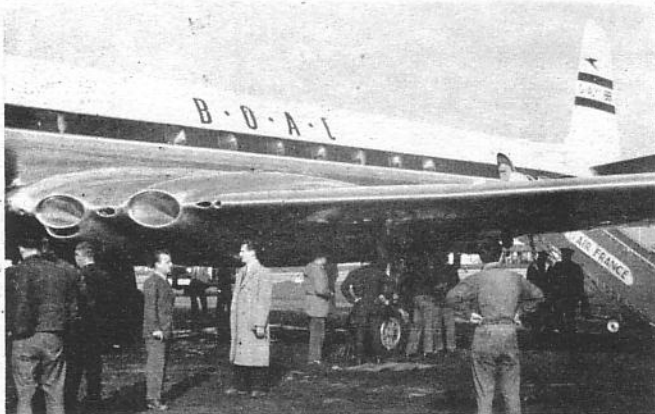
Figure 1 - Le premier Comet de la BOAC en présentation à Orly. Remarquer le carénage des entrées d'air et l'absence totale d'antennes sur le toit et la dérive.
