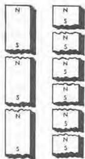
Fig. 4 - En sectionnant en plusieurs morceaux une barre aimantée, on obtient des aimants plus courts dont les pôles sont alternés.
