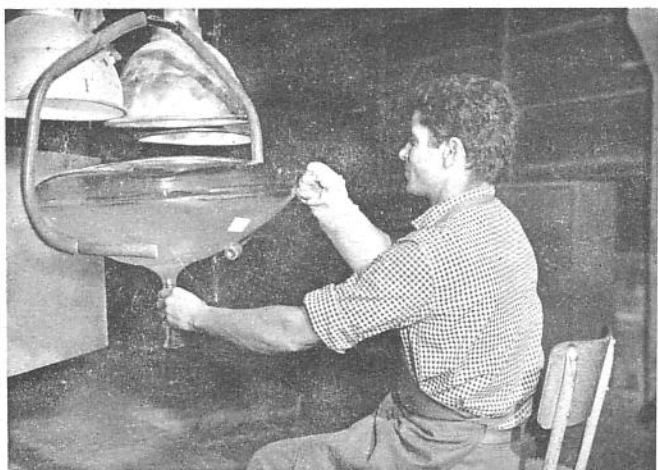
Contrôle des ampoules soudées d'un tube-image de télévision. (Document Sovirel).
