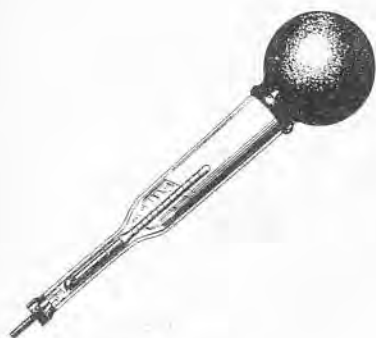
Fig. 11 - Densimètre à pipette pour contrôler le poids spécifique d'une solution. La position du flotteur indique la densité de l'électrolyte.
