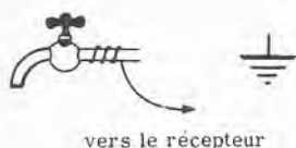
Fig. 22 - Prise de terre classique en ce qui concerne les possibilités présentes à la maison. À côté, le symbole schématique.
