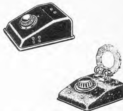
Fig. 23 - Deux coffrets en bakélite d'anciens types classiques pour récepteurs à cristal. Ils sont pourvus de trous pour la fixation des divers organes au moyen de douilles (comme on le voit à droite); dans cette figure on observera l'emploi d'une bobine en nid d'abeilles.
