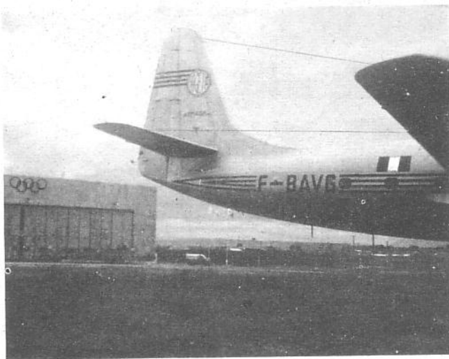
Fig. 2 - Sur cette photographie de l'arrière de l'avion, on peut distinguer les deux antennes H.F. et sous l'avion, à la hauteur des lettres A et V, le sabre VHF.
