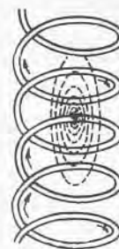
Fig. 15 - Un conducteur enroulé en spires rapprochées donne naissance à un champ magnétique plus intense, par le fait que les champs particuliers à chacune des spires s'ajoutent entre eux. On peut remarquer les lignes de force magnétique qui d'une spire influencent les spires adjacentes.
