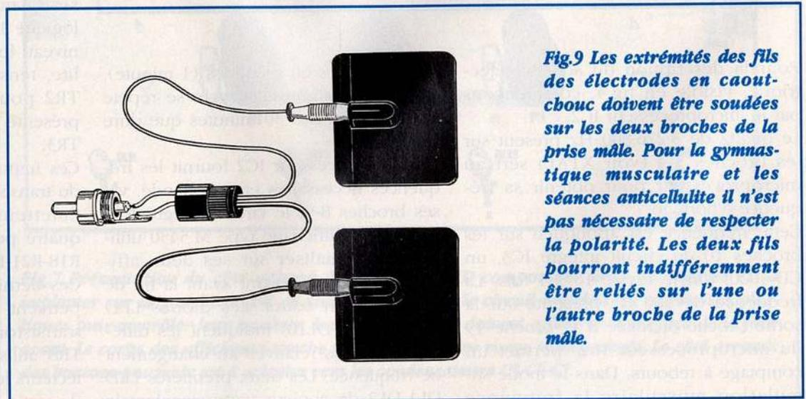
**Fig.9** Les extrémités des fils des électrodes en caoutchouc doivent être soudées sur les deux broches de la prise mâle. Pour la gymnastique musculaire et les séances anticellulite il n'est pas nécessaire de respecter la polarité. Les deux fils pourront indifféremment être reliés sur l'une ou l'autre broche de la prise mâle.
