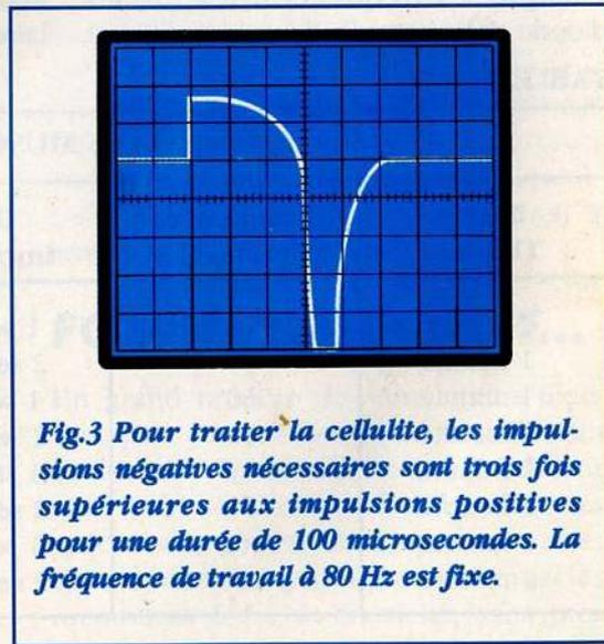
**Fig.3** Pour traiter la cellulite, les impulsions négatives nécessaires sont trois fois supérieures aux impulsions positives pour une durée de 100 microsecondes. La fréquence de travail à 80 Hz est fixe.
