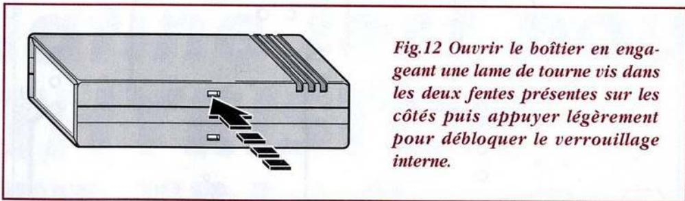
Fig.12 Ouvrir le boîtier en engageant une lame de tourne vis dans les deux fentes présentes sur les côtés puis appuyer légèrement pour débloquer le verrouillage interne.
