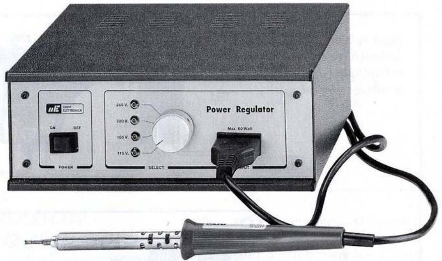
La disponibilité d'une tension supérieure procure l'avantage de rendre possible l'augmentation temporaire de la température de la pointe du fer à souder (panne), et souder ainsi sans difficulté aucune, des tôles de blindage ou des grosses cosses métalliques de connexion.
