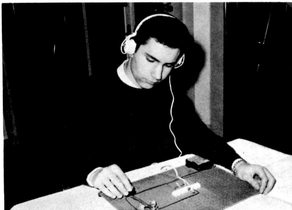
Il comporte essentiellement une bobine qui attire et fait vibrer une lamelle, celle-ci en vibrant ainsi fait entendre un bruit qui correspond à la cadence des signaux Morse qu'émet l'opérateur en manipulant.
