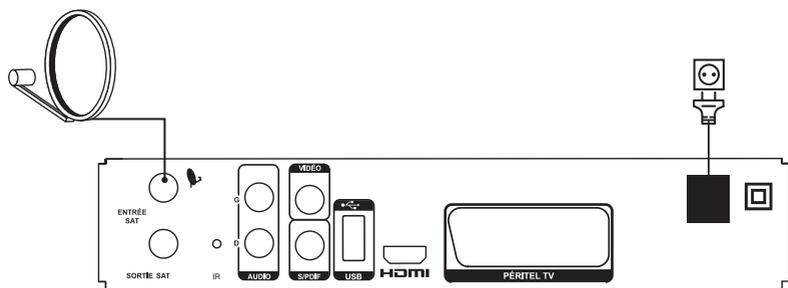
Votre parabole doit être orientée vers le satellite Astra à 19.2 Est. Demandez à votre revendeur d'orienter votre parabole sur ce satellite. Branchez un câble coaxial entre votre convertisseur LNB et le connecteur ENTRÉE IN de votre terminal.
