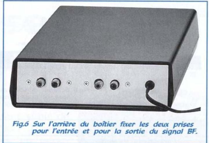
Fig.6 Sur l'arrière du boîtier fixer les deux prises pour l'entrée et pour la sortie du signal BF.
