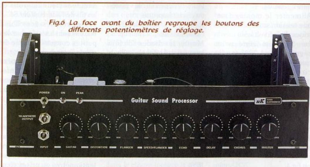
Fig.6 La face avant du boîtier regroupe les boutons des différents potentiomètres de réglage.
