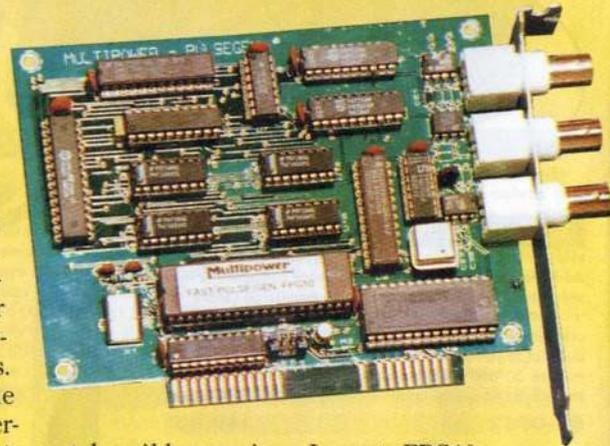
Les buffers de sortie 50 ohms fournissent des temps de montée de 3 nanosecondes.
