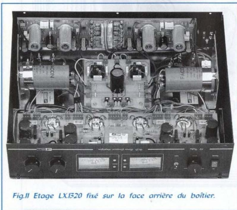
Fig.11 Etage LX1320 fixé sur la face arrière du boîtier.
