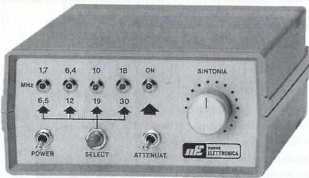
Fig. 4 La partie active de l'antenne logée dans un boîtier hermétique est réalisée à partir de modules CMS. Le pupitre de commande LX1078 (boîtier placé à gauche) contrôle le changement de gamme, l'accord fin sur l'émetteur recherché ainsi que l'atténuation pour les signaux d'amplitude trop élevée.
