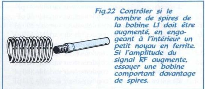
**Fig.22** Contrôler si le nombre de spires de la bobine L1 doit être augmenté, en engageant à l'intérieur un petit noyau en ferrite. Si l'amplitude du signal RF augmente, essayer une bobine comportant davantage de spires.
