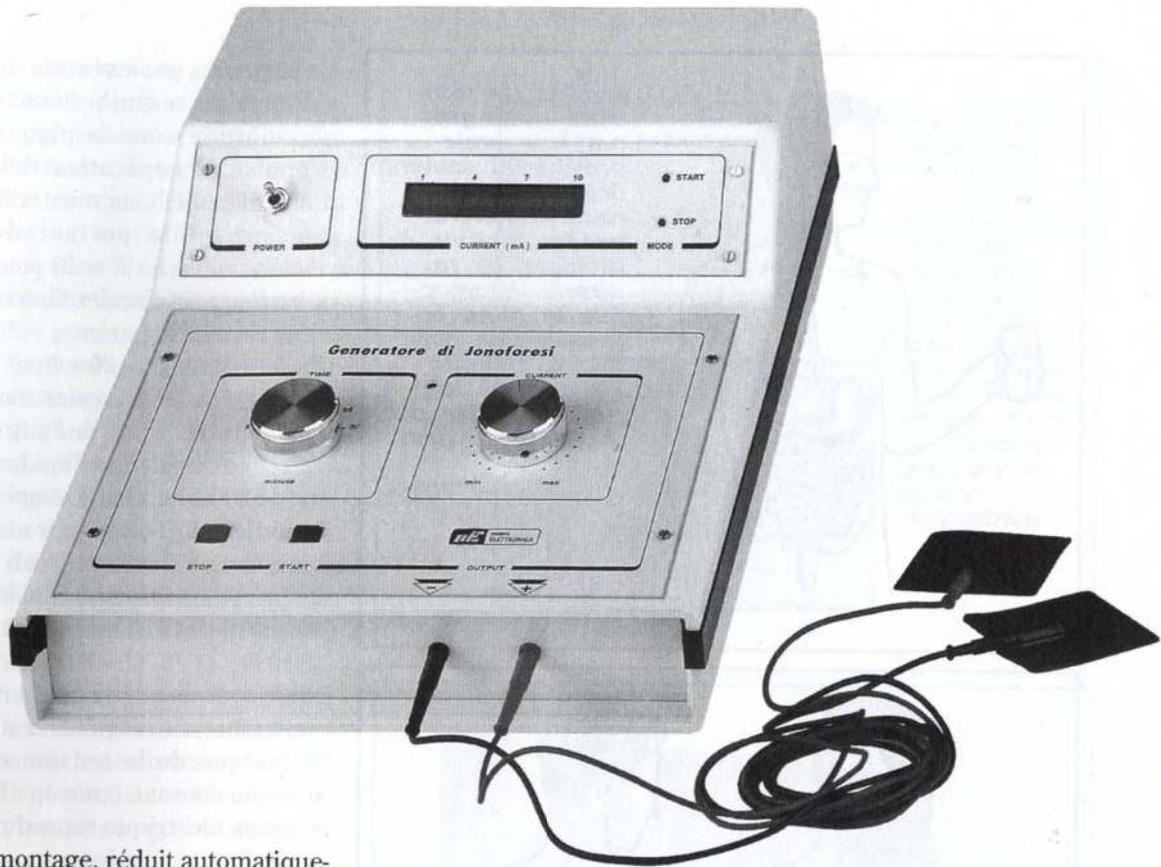
montage, réduit automatiquement le courant en présence d'une augmentation de la conductibilité de la peau. Il l'augmente également lorsque la plaque n'adhère plus parfaitement à l'épiderme.
