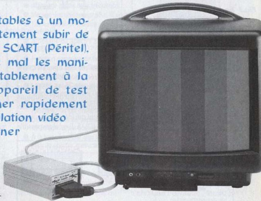
Fig.1 Il suffit de raccorder la sortie du montage à la prise Péritel d'un téléviseur pour procéder au test vidéocomposite RVB, commutation lente sans oublier le test de l'entrée audio.
