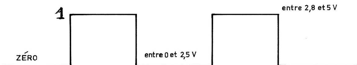
Fig. 9-27 - Les deux états d'un système linéaire. Par un codage approprié, ils suffisent pour représenter chiffres et lettres.
