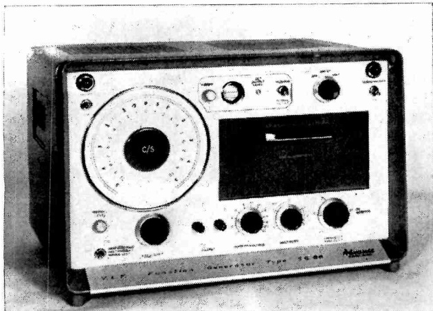
Le générateur T.B.F. SG 88 ADVANCE (Importateur LE-LAND RADIO IMPORT C o ). Fréquences couvertes : 0,005 à 50 Hz. Le panneau foncé est le couvercle du tiroir permettant le changement du disque qui, associé à une photocellule, engendre le signal.
