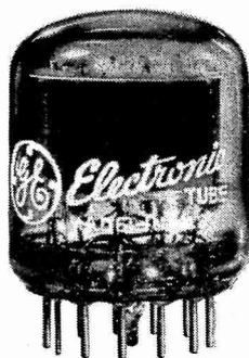
Les COMPACTRONS répondent à tous les besoins du créateur de montages, en commençant par une simple fonction électronique et en allant jusqu'à l'emploi d'une même électrode dans des fonctions multiples.
