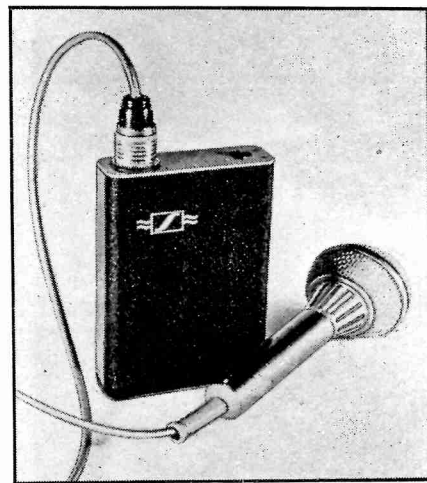
Le « Mikroport » (Sennheiser) est un émetteur de poche qui libère le conférencier du fil à la patte du microphone...
