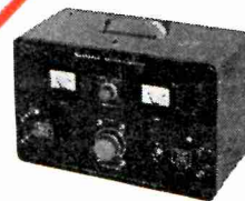
Alimentation basse tension filtrée
