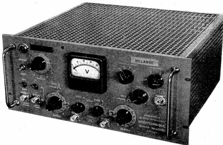
Un outil bien commode pour l'électronicien : le générateur à deux impulsions, réglables et retardables à volonté, d'INTERTECHNIQUE. Largeur des signaux : 0,8 à 150 \mu s ; retard de 1 à 100 \mu s ; récurrence de 1 à 11 000 Hz ; amplitude : 0 à 100 V ( Z = 1000 \Omega ) ou 0 à 50 V ( Z = 75 \Omega ).
