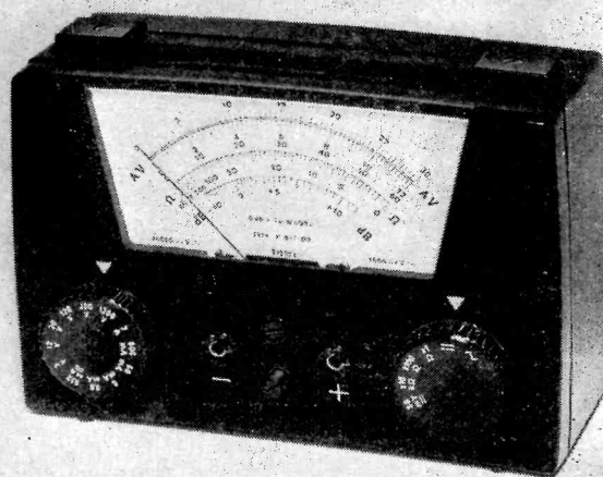
De Philips également, ce contrôleur universel P817, dont le trait particulier est l'échelle commune continu-alternatif.
