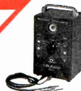
Appareil pour vérification des condensateurs en circuit
