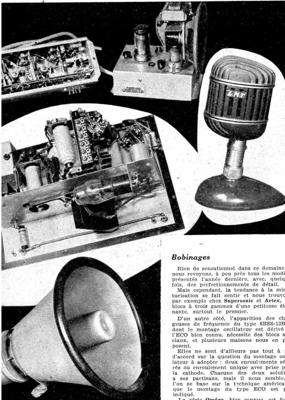
De haut en bas et de gauche à droite — Blocs de télévision Ducastel, à gauche, bloc récepteur « image », à droite, bloc récepteur « son ». — Intérieur du nouveau générateur H.F. Audiola. — Microphone cardioïde L.M.T. — H.P. Babyflex Bouyer de 25 cm de diamètre à chambre de compression.
