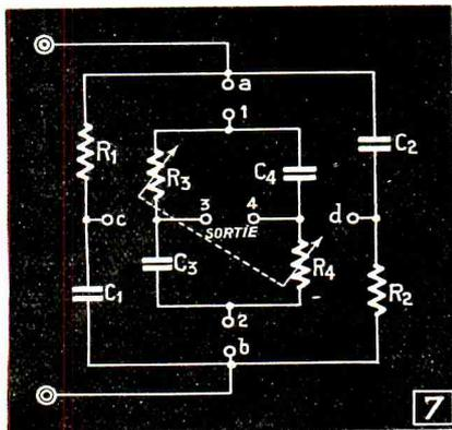
talement par production sur l'écran de l'oscillographe d'une ellipse correspondant à un déphasage connu. En compensant ce dernier avec l'aide du système décrit, on arrive à transformer l'ellipse en une ligne droite. On en déduit que la variation des résistances du système correspond à un déphasage égal à celui de l'ellipse connue. La précision de l'étalonnage dépend en grande partie de l'exactitude de la fréquence, car les valeurs de R<sub>3</sub> et R<sub>4</sub> dépendent de cette fréquence.
