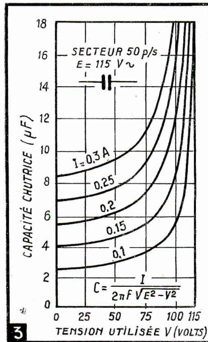
et branché, à travers  $C$ , sur un secteur de  $E = 115$  volts. L'abaque donne immédiatement  $C = 5,2 \mu F$ . La tension aux bornes du condensateur sera, conformément à l'égalité (4).
