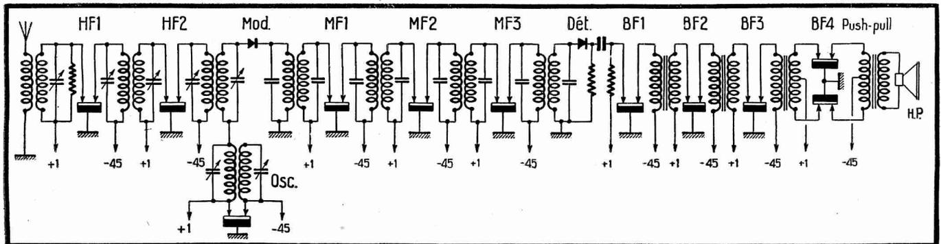
Fig. 3. — Schéma... très schématisé du récepteur de démonstration des Laboratoires Bell. Pas une lampe, mais en revanche 11 transistors, 2 détecteurs au germanium et 2 redresseurs à oxyde de cuivre. C'est la victoire des semi-conducteurs sur les tubes à vide !
