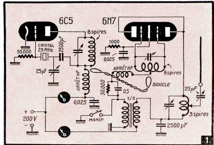
Fig. 1. — Schéma de principe de l'émetteur servant indifféremment pour la télécommande du bateau ou de l'avion.
