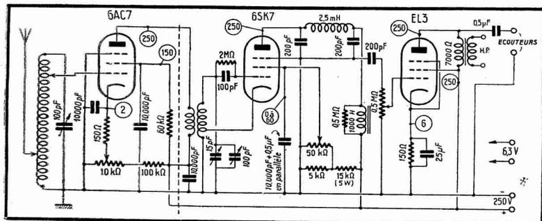
Fig. 1. — Schéma de principe du récepteur à trois tubes pour O.C. et P.O.
