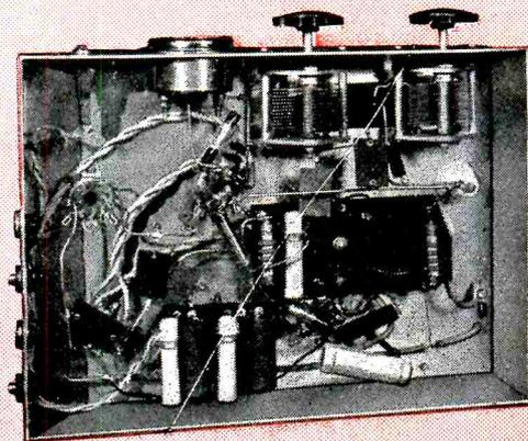
Le châssis de l'émetteur vu par dessous.
