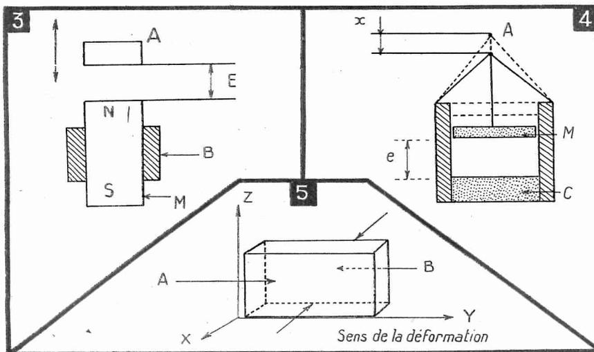
La figure 5 représente une lame de quartz taillée perpendiculairement à l'axe électrique du cristal. On sait que si les faces A et B d'une telle lame sont soumises à des pressions, des charges électriques apparaissent sur chacune de ces faces. La valeur de ces charges suit très exactement les variations de pression exercées sur la lame piézo-électrique.
