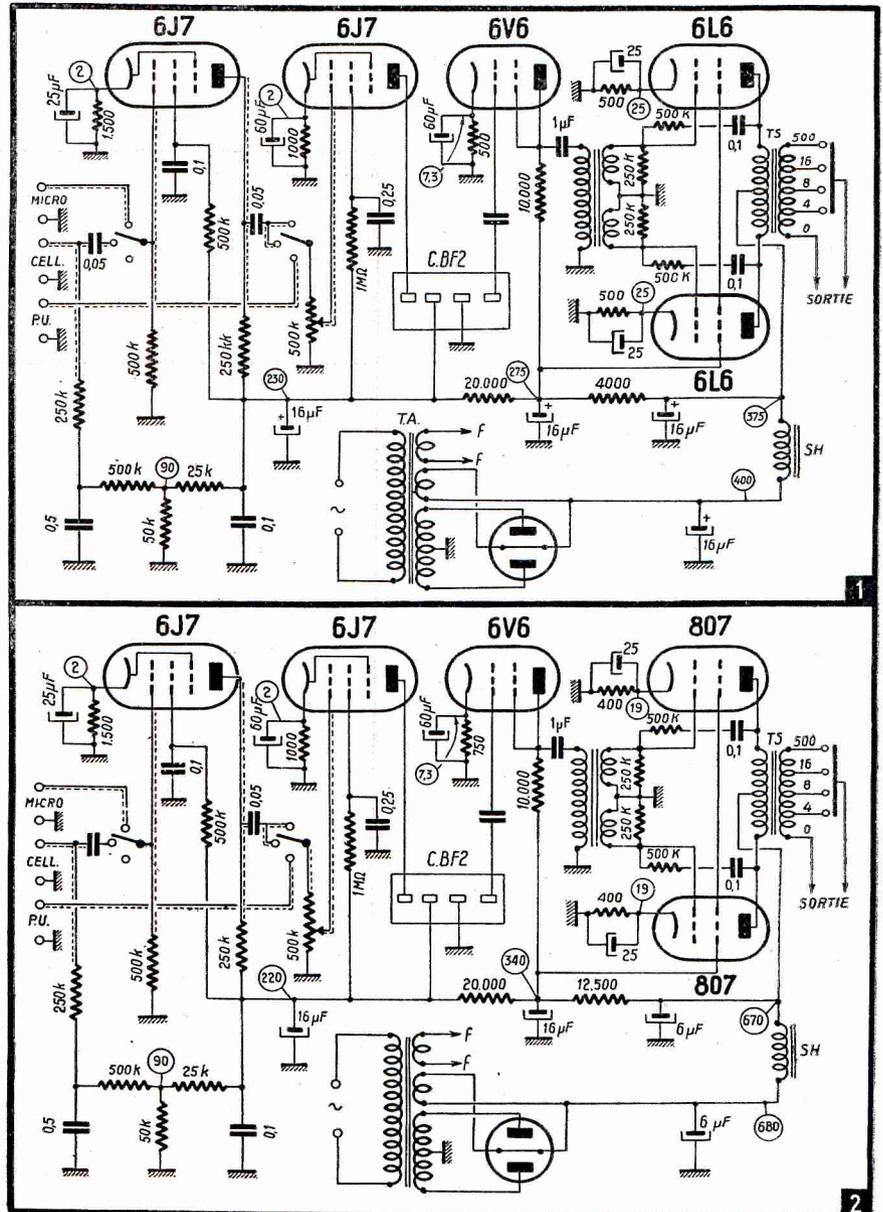
Fig. 1. — Schéma de principe de l'amplificateur B.F. 15 W. La valve est une 5Y3GB.
