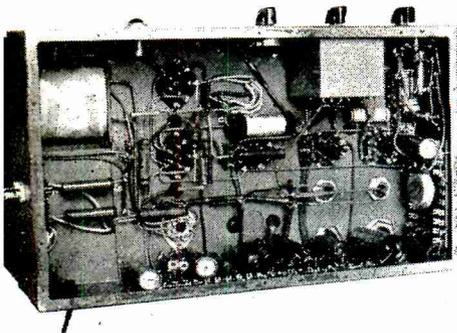
Vue intérieure de l'amplificateur 50 W. L'usage de plaquettes pour résistances et condensateurs, permet d'obtenir un câblage aéré qu'il est facile par la suite de vérifier ou de dépanner.
