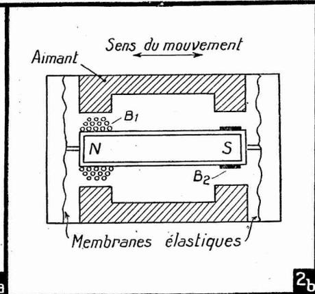
une force alternative entre la tige exploratrice et le boîtier. Cette force est en général suffisante pour faire vibrer des systèmes mécaniques de faible masse. Ce modèle de capteur de vibrations peut donc être également utilisé comme excitateur.
