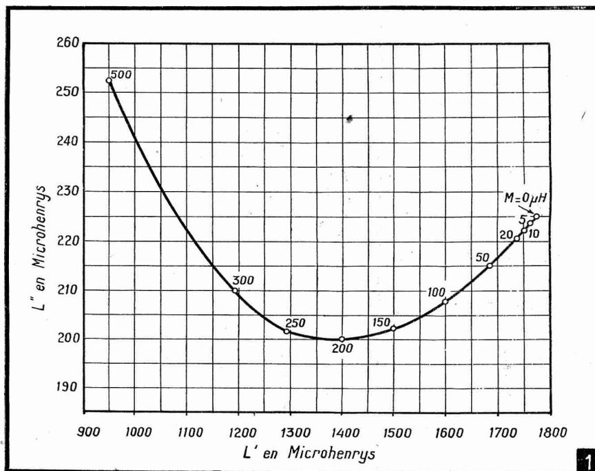
Fig. 1. — Variation du coefficient de self-induction de l'un des enroulements en fonction de l'autre pour différentes valeurs de la mutuelle induction.
