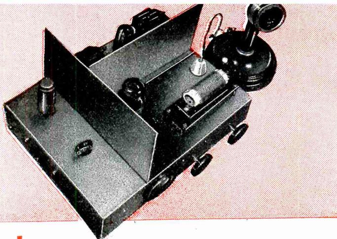
Des blindages séparent l'émetteur en trois compartiments : étage pilote avec quart (à gauche), étage de puissance (à droite) et modulateur (derrière). L'alimentation est montée sur un châssis séparé.
