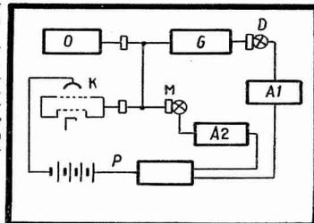
Fig. 2. — Schéma de principe d'un montage stabilisateur utilisant les raies spectrales : O, oscillateur ; G, cellule à gaz ; D, détecteur à cristal ; A<sub>1</sub>, A<sub>2</sub>, amplificateurs ; M, mélangeur à cristal ; K, klystron stabilisateur ; P, détecteur de phase.
