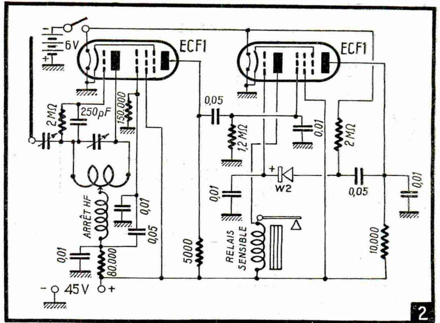
Fig. 2. — Schéma de principe complet du récepteur avion.
