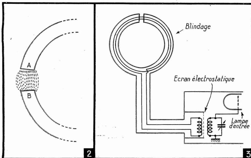
Fig. 2. — Apparition du champ électrique à la coupure d'un cadre blindé.
