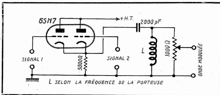
qu'un signal agissant sur une grille soit modulé par un autre, injecté dans l'autre grille.
