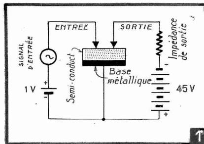
Fig. 1. — Nous rappelons ici le schéma fondamental du transistor.
