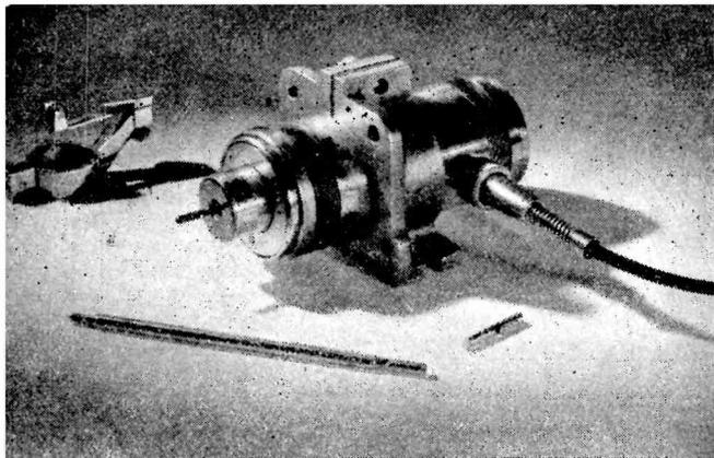
★ Capteur électrodynamique Philips GM-5526 et diverses pièces de contact pour étude des vibrations. ★
