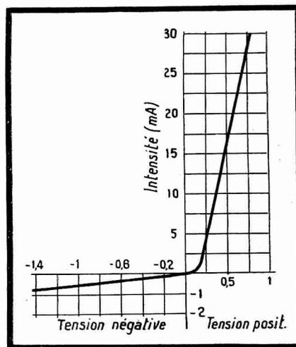
Fig. 2. — Caractéristique d'un détecteur au germanium. On voit combien le courant dans le « bon sens » est supérieur à celui allant dans le « sens interdit ».
