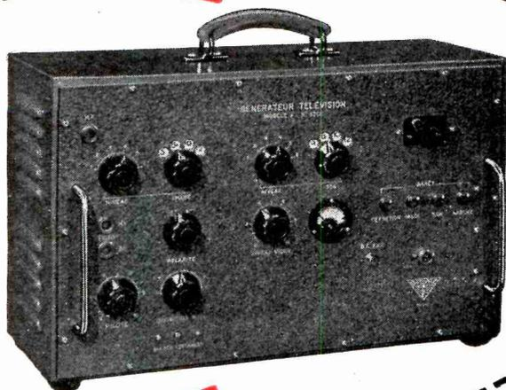
4 Canaux - fréquences au choix. - Porteuses H. F. Image et Son stabilisées par quartz. - Signaux de synchronisation conformes au standard officiel. - Contrôle de la bande passante jusqu'à 10 Mc/s. - Sortie vidéo 75 ohms - tension 1,5 volt. - Commutateur de polarité - Contrôle des niveaux Image et Son indépendants - Sortie unique 75 ohms. - Entrée pour modulation extérieure de la porteuse H. F. Son.
