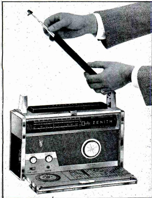
Le « Trans-Oceanic » comporte trois antennes. L'une, télescopique, de 90 centimètres maximum, est escamotée au repos dans la poignée; c'est l'aérien pour ondes courtes. Les P.O. sont normalement reçus à l'aide d'un enroulement sur ferrite incorporée. Une troisième antenne ferrite, mobile, et munie de ventouses, est plaquée contre une vitre pour l'utilisation à bord de véhicules ou dans les immeubles métalliques.
