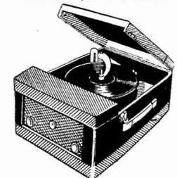
Electrophone de luxe en valise, équipé du changeur automatique « Collaro » RC 456 à 4 vitesses pour 10 disques. Pick-up non hygroscopique à 2 saphirs. Ampli à 2 étages et contre-réaction, tonalité réglable. Haut-Parleur puissant et fidèle. Coffret en bois léger à revêtement simili cuir, deux tons, très résistant. Secteur alternatif. 100 à 250 V. (220 × 355 × 470). Poids 11 kg. Prix net spécial Paris **28.950**
