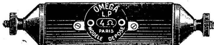
Alors que toutes les résistances en cartouches ont été établies jusqu'à présent, dans des tubes cylindriques isolants, la plupart du temps en verre ou en quelqu'autre matière fragile, dans les résistances Modèle N° 6 on utilise pour éviter une trop grande fragilité un tube métalliques en forme octogonale comme boîtier de protection.
