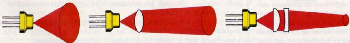
*Fig.6 Le faisceau diffusé par une diode laser a une divergence importante et sans un objectif adapté il est difficile d'obtenir un petit point lumineux. Les objectifs pourvus de plusieurs lentilles focalisent mieux le faisceau laser.*
