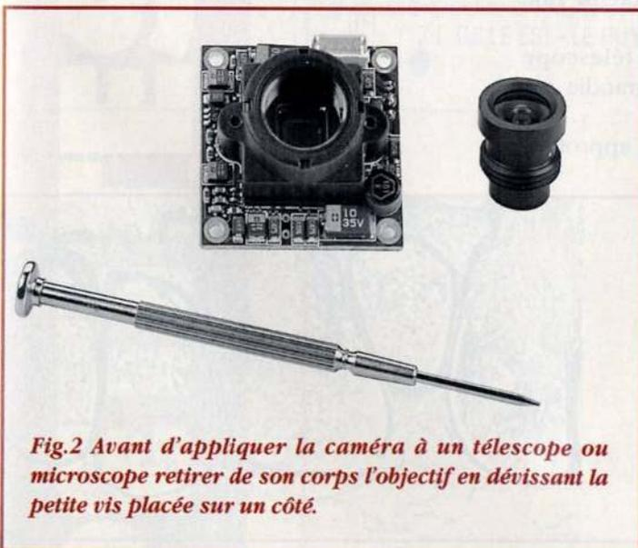
**Fig.2** Avant d'appliquer la caméra à un télescope ou microscope retirer de son corps l'objectif en dévissant la petite vis placée sur un côté.
