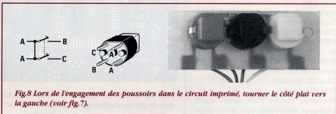
Fig.8 Lors de l'engagement des poussoirs dans le circuit imprimé, tourner le côté plat vers la gauche (voir fig.7).
