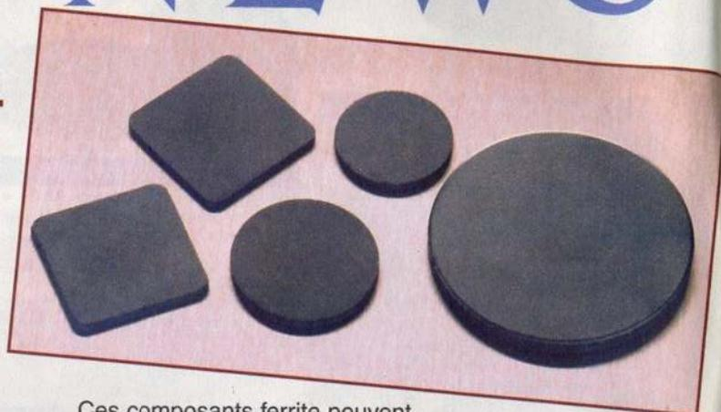
Ces composants ferrite peuvent être utilisés autant en composant de couplage inductif qu'en blindage inductif. En couplage inductif, le ferrite affecte la forme d'onde du signal émise par le circuit. Le temps de montée est ralenti et sa suroscillation s'en trouve atténuée. Le blindage inductif consiste pour le matériau ferrite à absorber les interférences émises par rayonnement, protégeant ainsi les cartes ou composants environnants de ces interférences.
