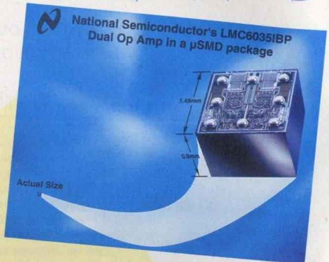
rieures, une plus grande facilité de montage et une résistance exceptionnelle à l'humidité. Après montage, en utilisant les outils et méthodes de soudure standards, il n'est pas nécessaire d'effectuer un enrobage complémentaire, cela réduit les coûts et simplifie la fabrication des cartes, tout en rendant possible leur modification ultérieure.
