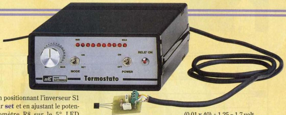
Pour que le thermostat déclenche quand la température descend de 0,5 degré, il est nécessaire de restreindre encore la plage de mesure.
