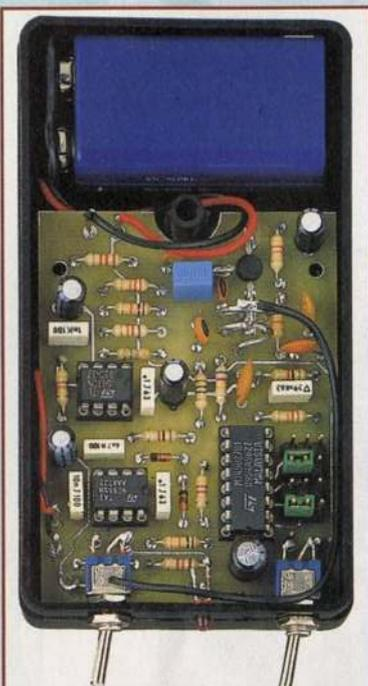
**Fig.19** Platine récepteur installée dans le boîtier. Noter le fil d'antenne.
