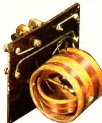
Fig.31a Homemade Crystal Set II (1920s) Une autre fabrication artisanale intéres- sante que cet ensemble à galène fabriqué à partir de planchettes provenant d'un cageot de pomme ! Les côtés sont juste cloués ensemble pour accueillir un large couverture mal ajusté. Sur la droite le détecteur sur la plaque noire gravée "J-K. CORP."
