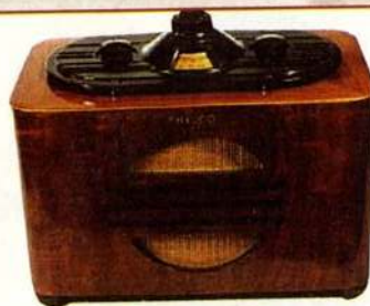
Fig.15 Philco 37-604 (1937) Une radio atypique. Equipée d'un cadran conique rétro éclairé, sur lequel figurent les bandes AM et les ondes courtes, le bouton d'accord concentrique Gros fin est placé sur le dessus aux côtés du contrôle de volume et du sélecteur de bande. L'ébénisterie habille aussi élégamment l'arrière du poste.
