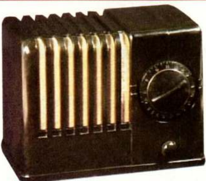
Fig.27 Silvertone 4500A (1936) Apparition des premières radios en coffret plastique. Le tissu derrière la grille n'est pas d'époque.
