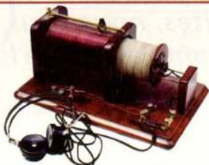
Fig.30 Homemade Crystal Set I (années 1920) Ce poste à galène de fabrication maison est probablement à dater du milieu des années 20. Les ondes radio sont détectées par un cristal de galène et une aiguille, montage visible au-dessus des écouteurs. L'accord est assuré par emboî- tement des bobines. Cet ensemble est construit sur une plaque provenant d'une ancienne machine à coudre.
