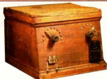
Fig.31a Homemade Crystal Set II (1920s) Une autre fabrication artisanale intéres- sante que cet ensemble à galène fabriqué à partir de planchettes provenant d'un cageot de pomme ! Les côtés sont juste cloués ensemble pour accueillir un large couverture mal ajusté. Sur la droite le détecteur sur la plaque noire gravée "J-K. CORP."
