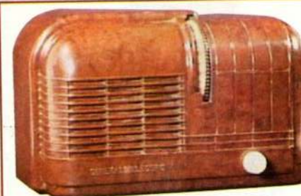
Fig.24 General Electric H-500U (1939) Un modèle étonnant et compact (22cm de longueur) offrant une impression de robustesse par son look de locomotive. L'accord s'opère par une large molette placée au centre.
