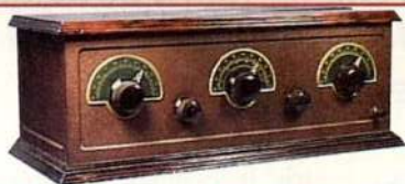
Fig.29 Stewart-Warner 300 (1925) Un châssis radio métallique typique du milieu des années 20 : Trois cadrans, une alimentation par batteries, et cinq tubes identiques. Ce spécimen constitue un exemple de réalisa- tion soignée ; dessus, dessous et fond sont habillés de bois alors que les flancs et la face avant sont de métal. Les cadrans sont en verre couleur émeraude avec un encadre- ment en bronze. Le capot supérieur s'ouvre et révèle une électronique dont la disposi- tion est très aérée. Ce type de radio nécessi- tait un haut-parleur externe.
