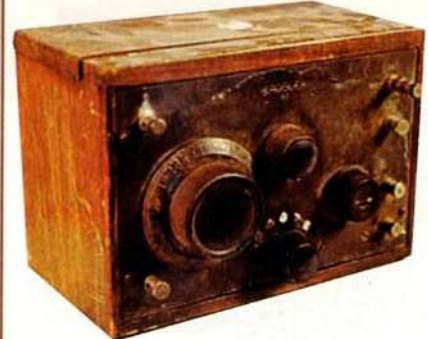
Fig.11a Crosley 50 (1924) Voici un petit monotube. Comme vous pouvez le voir, cette radio brute de fabrication est sans superflu. Mais techniquement tout est là !
