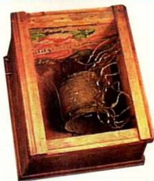
Fig.31b Homemade Crystal Set II (1920s) Cette embase ressemble à des modèles produits autour de 1929. Les dimensions sont approximativement de 30 x 25 cm.
