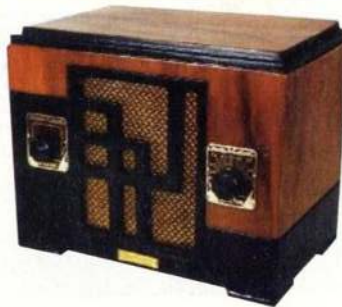
Fig.12 Davison (années 30) Une ébénisterie typiquement art déco du milieu des années 30. Equipée de 4 lampes elle a été magnifiquement restaurée à partir du schéma du "Rider's Volume 6 under "Westone Radio Corp," page 6-2.
