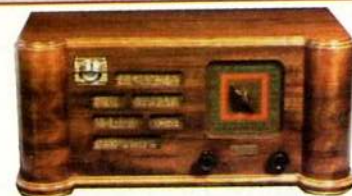
Fig.16 "Supreme" (années 30) Un imposant poste dont le seul identifiant est la plaque marquée "Supreme". Son ébénisterie originale évoque un château-fort flanqué de ses deux tours. Equipé de quatre tubes (25Z5, 25L5, et deux 6C6), deux ballasts, et d'un œil magique. Le bouton de réglage des stations est directement en relation avec le condensateur d'accord. Le cadran est rétro éclairé et comporte des inscriptions en couleur.
