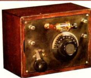
Fig.32 Homemade Crystal Set III (1920s) Astucieux assemblage que celui de ces trois bobines. Ce poste à galène dispose d'un gros bouton qui fait tourner l'une des bobines par rapport aux deux autres pour changer l'inductance et accorder la radio sur la station à recevoir. Le détecteur proté- gé par un tube de verre est une copie maison, d'un modèle en bronze usiné courant à l'époque. Les dimensions du coffret sont d'environ 20 x 10 x 8 cm.
